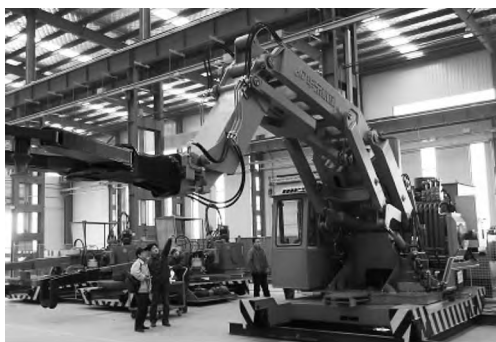
图5 全液压重载机器人
