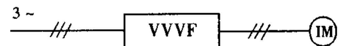
图 1 开环异步机变频调速 VVVF—通用变频器; IM—异步电动机
