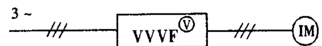
图 2 矢量控制变频器的异步电机变频调速 VVVF—矢量变频器
