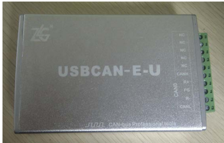
图 1.1 USBCAN-E-U 工业级 CAN 接口卡
