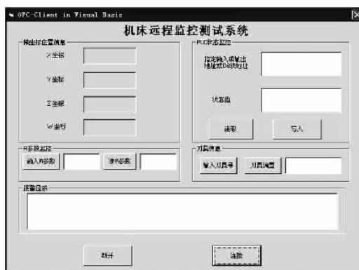
图7 机床远程监控测试系统界面
