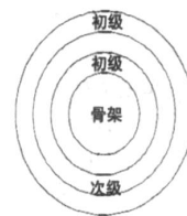
图 2 线圈“三明治”绕制图
