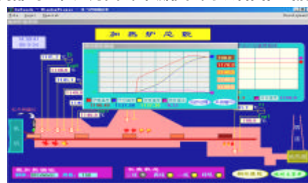
图5 加热炉主流程及钢坯跟踪画面
